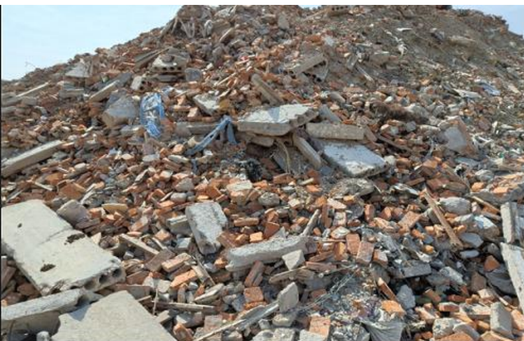
低纯建筑垃圾 ( 拆房、拆违、整治 )
